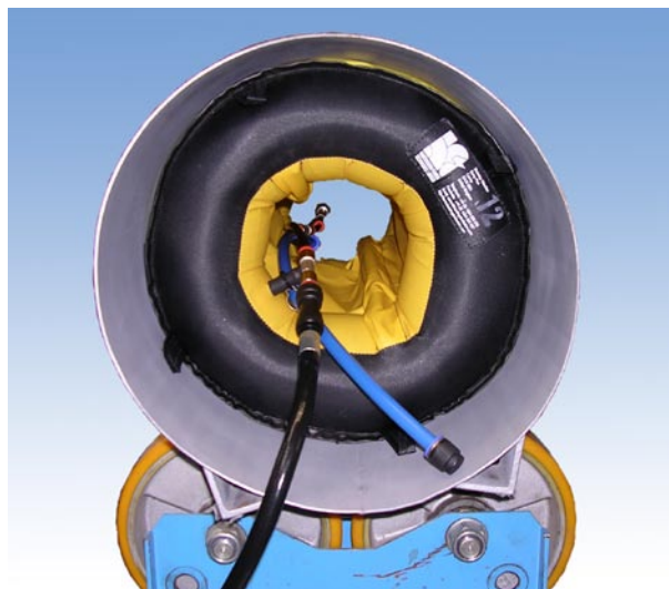
12-TUUMAN QUICK PURGE -JÄRJESTELMÄ PUTKESSA
